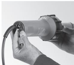
2. Régler le potentiomètre à la température souhaitée.
