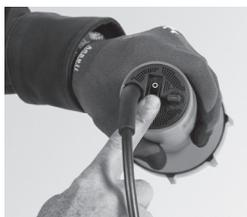
Le pistolet à air chaud est doté d'une fonction d'arrêt différé pour le refroidissement. Ne pas régler le bouton de température sur «0» après le travail.
